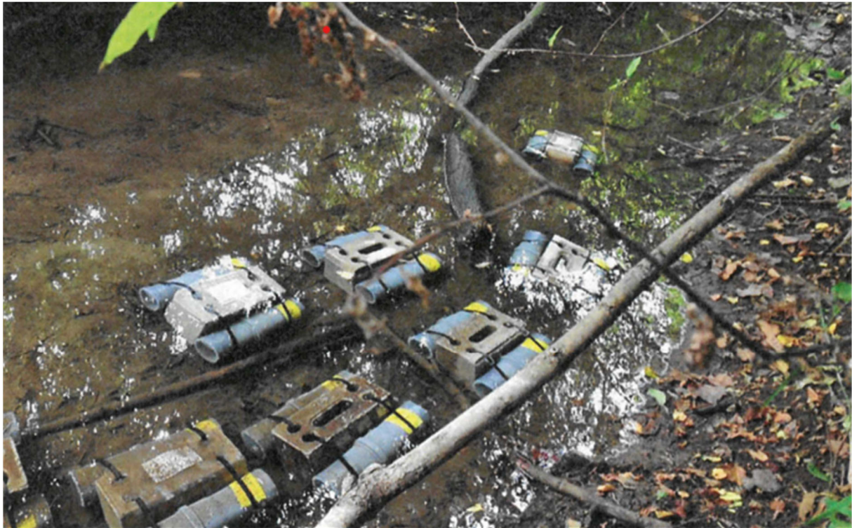
Abbildung 2: spezielle Versuchs - Kisten mit Bachflohkrebsen um die Veränderung der Gewässergüte festzustellen (Foto: Chelsea Little, EAWAG) 2
