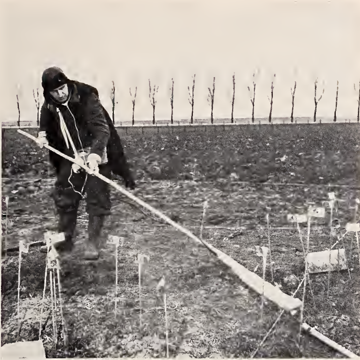
Abb. 4: Messen mit Szintillationsdetektor am Lot der vorhergegangenen Registrierung (Schlüsselpunkt: reflektierender Leuchtstab; Fahnen werden zur Vermeidung von Störungen und Verletzungen des Tieres sowie aus Gründen des Strahlenschutzes erst gesteckt, wenn das Versuchstier den Ort wieder verlassen hat).
