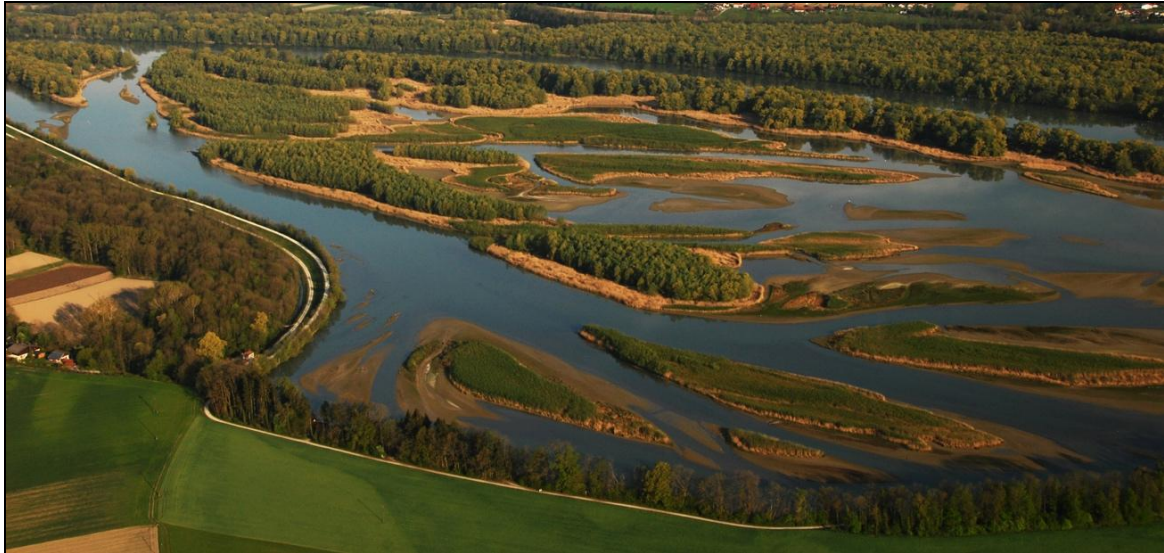
Abb. 2: Verlandung und Inselbildung als Charakteristikum der Stauseen am unteren Inn. Hier bildet ein Seitengerinne ein Binnendelta in der ehemaligen tiefen „Hagenauer Bucht“ bei Braunau am Inn. Der Einstau ermöglichte es dem kanalisierten Strom sich naturnah zu entwickeln. Die neu entstandene Struktur schaffte Biodiversität.
