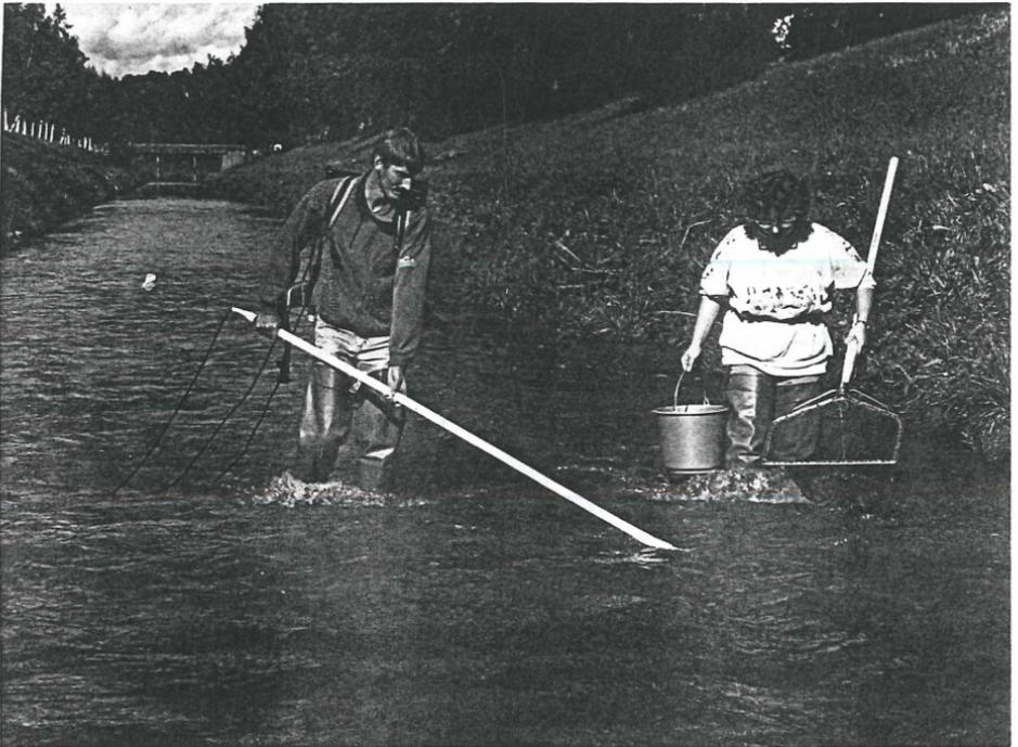
Befischung eines Fließgewässers mittels tragbarem Gleichstromaggregat
