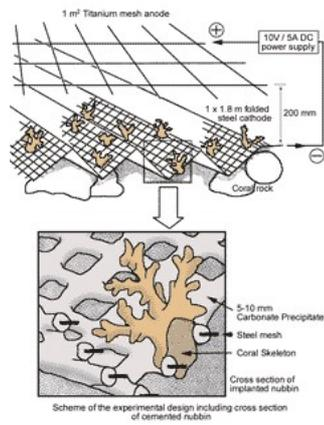
Abb. 2. Schema der elektrochem. Abscheidung von Carbonat (modifiziert nach: Trecek & Schuhmacher, 1997)
