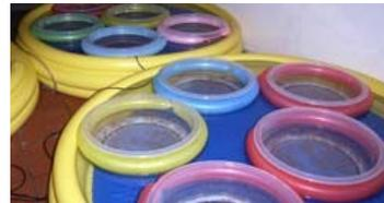
Abb. 2. Versuchsanordnung zur künstlichen Korallenlarvenaufzucht bestehend aus 2 Becken enthaltend 150 Liter temperiertes Meerwasser mit Strömungspumpen.
