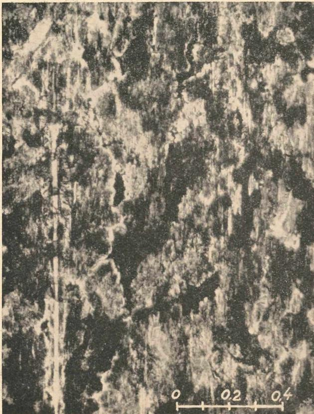
Abb. 9: Dünnschliff einer Paramorphose von Fasergips nach Gipskristallen aus Pöttching. Schliff  $\perp$  auf die c-Achse. + Nic.
