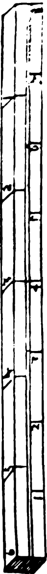
Abb. 2: Seite 4 r aus dem Buche von Chr. Puechler (1563). In natürlicher Größe die Hälfte vom „Werckschuech“ (Originalgröße).
