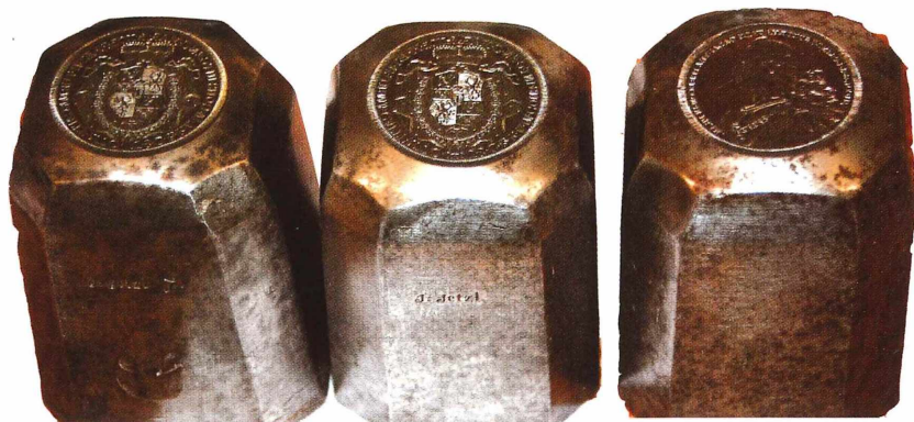
Drei Stempelisen: zwei Rückseiten, jeweils von Jetzl signiert, und eine Vorderseite. Abb. 6a
