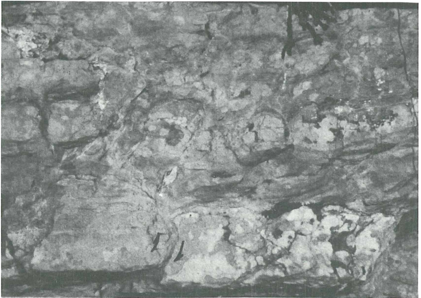
Abb. 33: Ausschnitt einer Flaserkalk-Eingleitscholle mit zerlegten Bänken (s. Pfeile). Profil 8–5, Schönwipfelkonglomerat, Schönwipfel-Hangendeinheit.
