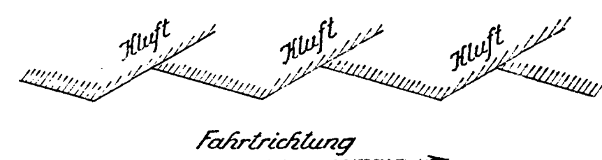
Abb. 2. Aussehen der Schneemauer am Straßenrand nach dem Pflugfahren.
