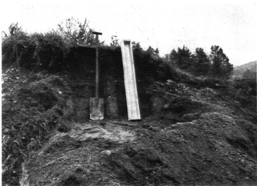
Abb. 1. Entnahme der Bodenproben nach der Monolith-Methode
