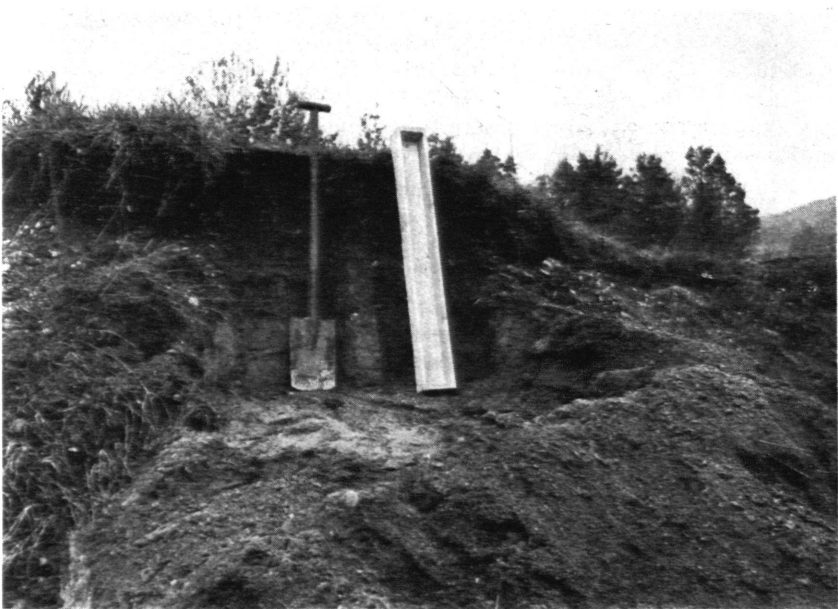
Abb. 1. Entnahme der Bodenproben nach der Monolith-Methode
