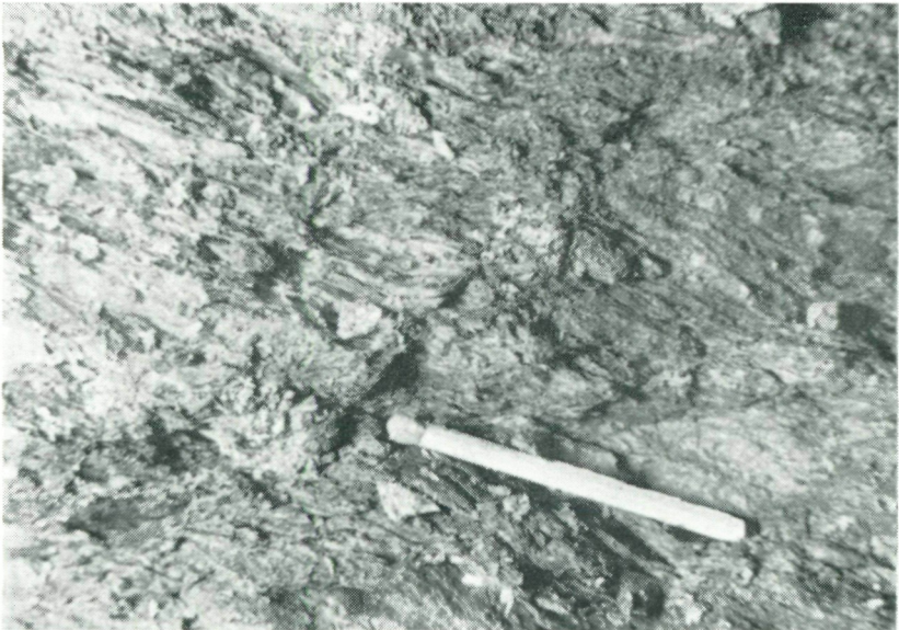
Abb. 2: Ausbildung der Bewegungslinearen an mylonitischen Störungsflächen 285/60
