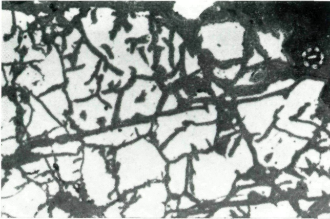
Abb. 5: Schliff einer Probe aus dem Bergbau Ma. Rosen. In den Rissen und Sprüngen der zwar vielfach zerbrochenen (zerdrückten), aber nicht weiter deformierten Fahlerzkörnchen (weiß) treten die verschiedenen Cu-Oxydationsminerale auf. Rechts oben ein Pyritkörnchen (punktierter Kreis). 25,2 x, 1 Po. Foto: J. G. HADITSCH, 1971
