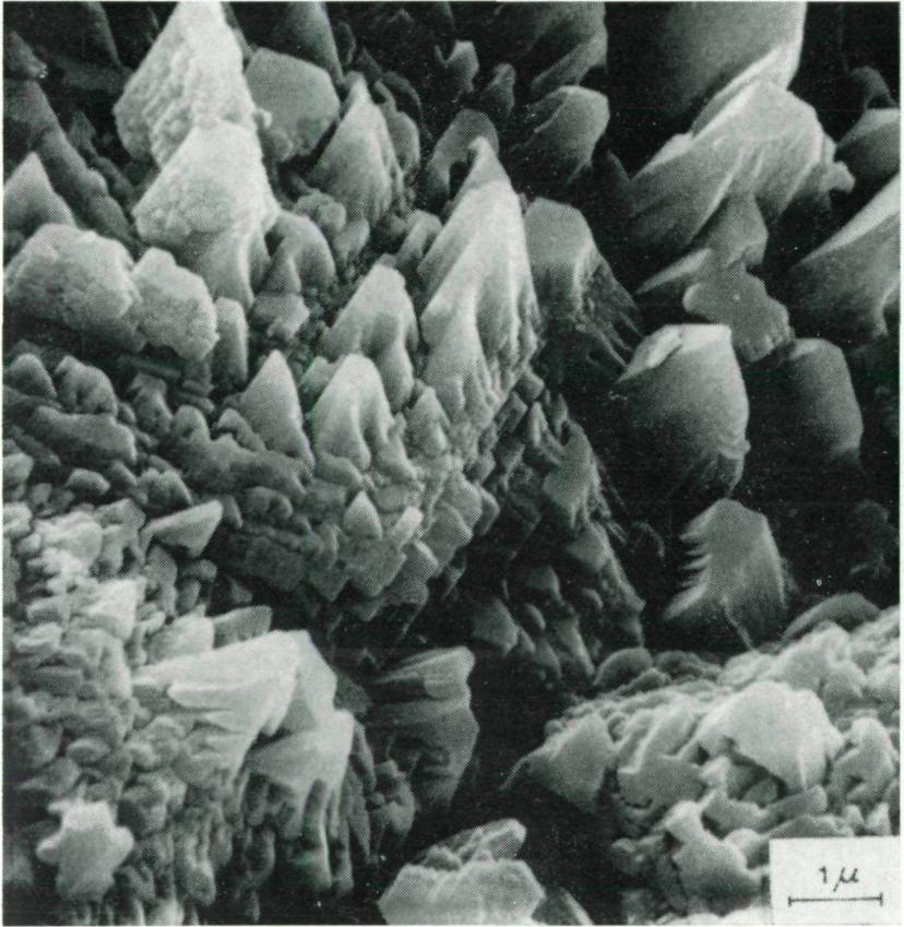
Abb. 9: Vollständige Kalzisierung der Oberflächen von Zementbruchstücken nach Einwirken von kohlensäurehaltigem Wasser.
