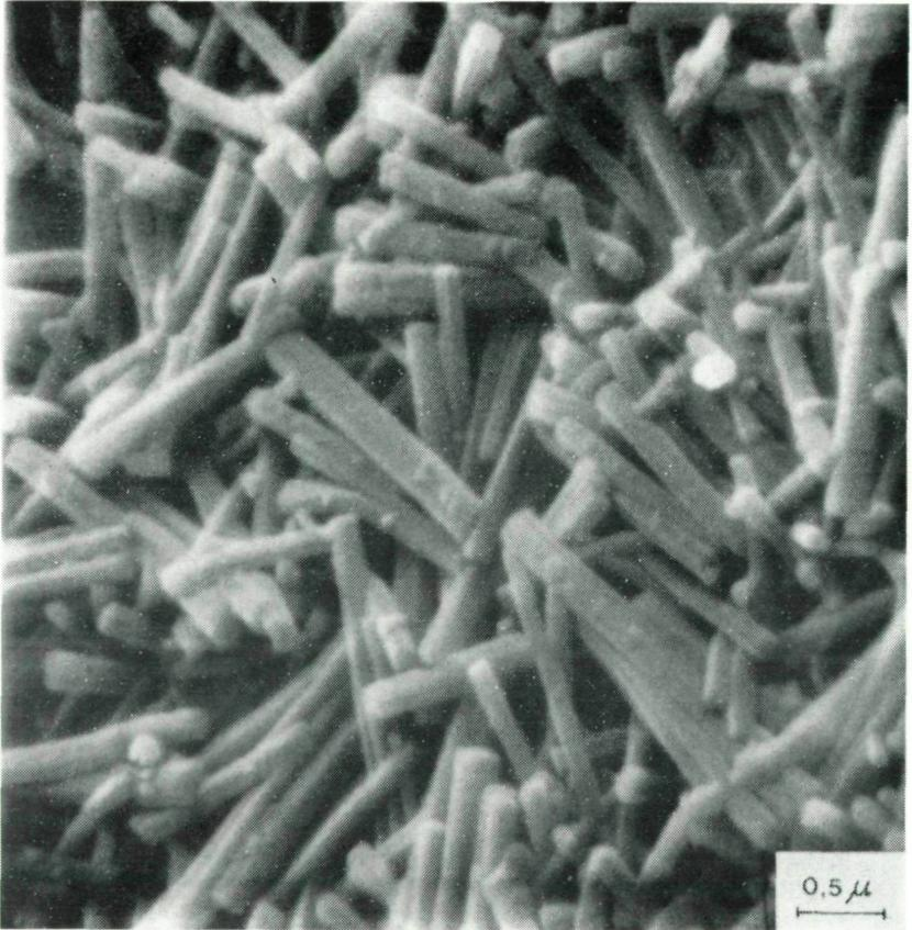
Abb. 1: Feinkristalline Etringitgrundmasse.
