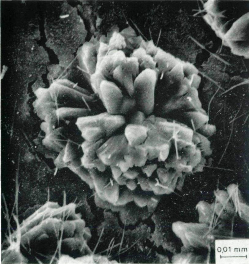
Abb. 6: Rosettenförmige Kalzitneubildungen aus amorpher Grundmasse.
