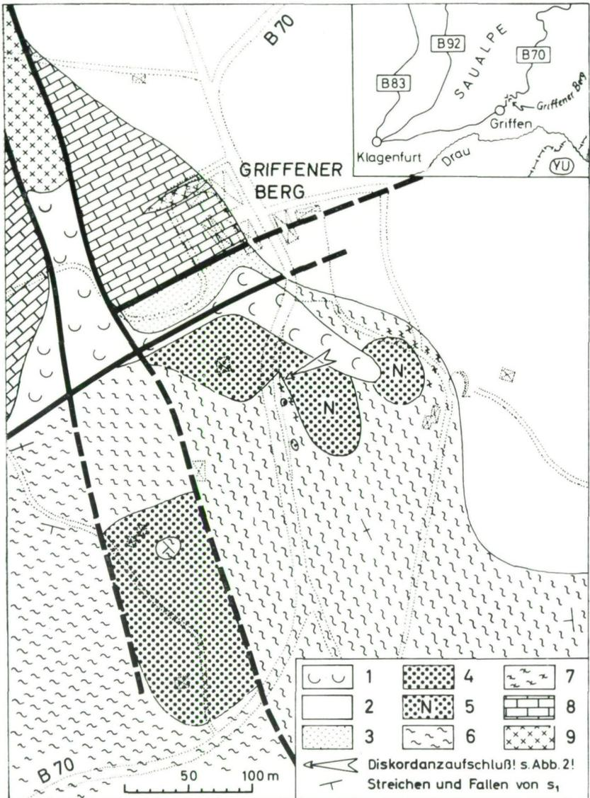
Abb. 1: Geologische Kartenskizze der Gegend um den „Griffener Berg“, Ost-kärnten (unter Verwendung der Aufnahmen von KLEINSCHMIDT & WURM 1966 und SEEGER 1974). 1 = Quartär; 2 = Tertiär: Granit talschotter; 3 = Werfener Schichten; 4 = Permoskyth sandstein; 5 = neu gefundenes Permoskyth; 6 = sehr-schwach-metamorphes Altpaläozoikum („Magdalensbergserie“); 7 = wie zuvor, mit roten Fe-Oxid-Häuten; 8 = schwach-metamorpher Marmor; 9 = schwach-metamorphe Metavulkanite.
