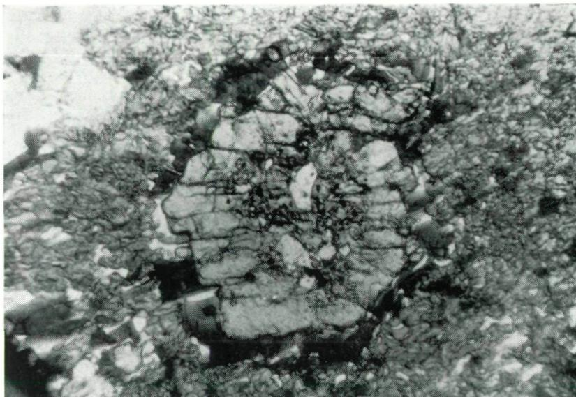
Abb. 2: Kelyphitamphibolit aus dem Krastal, Kärnten. — Ein Pol., Durchlicht. — Granat ( $\varnothing = 0,96$  mm) mit Einschlüssen von Quarz, Epidot und kleinsten Rutilkörnchen. Die den Granat allseitig umschließende Kelyphitschale tritt im Bilde infolge der sie aufbauenden bläustichigen Hornblende gegenüber der feinkörnigen, sehr hellen Hornblende des Grundgewebes deutlich hervor.
