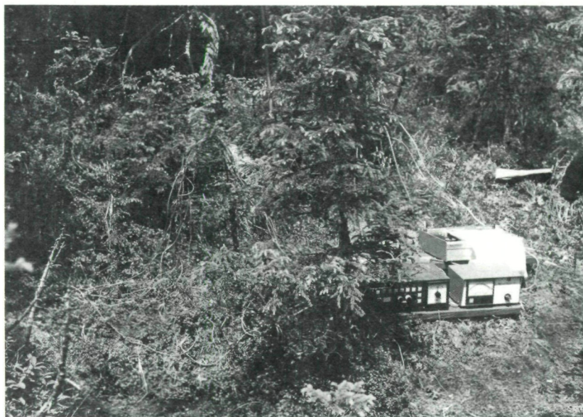
Abb. 4: Die Bodentemperatur-Meßanlage am Meßplatz A (Eis) in einem Krüppelfichtenbestand.
