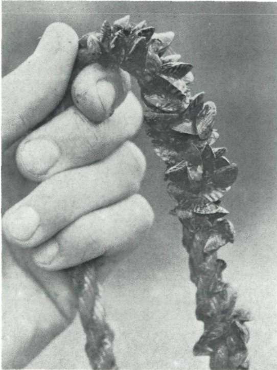
Mit Wandermuscheln dicht besetztes Kunststoffseil nach einjähriger Exposition im See.
