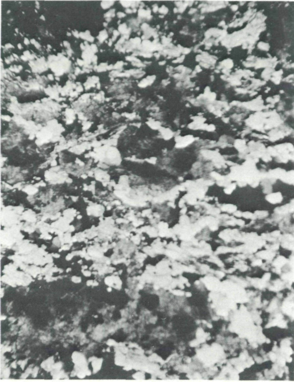
Abb. 5: In s gelängte Siderit-, Quarz- und Glimmer-Aggregate zufolge Tektonitregelung einer feinlamierten Abfolge. Dünnschliff, Nicols +; natürliche Größe des Ausschnittes 7×5 mm. Siderit: verschieden grau (undulös!), Quarz und Sericit weiß bis grauweiß.
