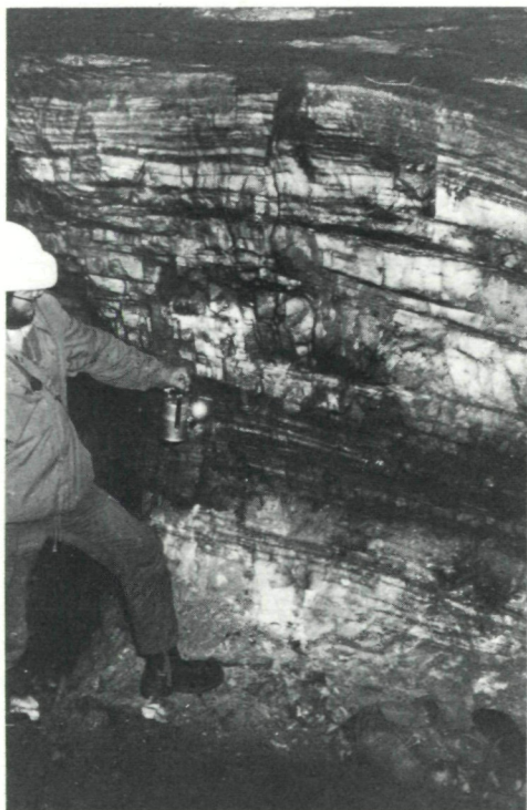
Abb. 5: Klausengrube im Radlgraben bei Trebesing. Ausschnitt aus dem Haupterzlager im Barbara-Stollen (Fundstollen), etwa im Bereich des tiefergelegenen, kleineren Verhaues. Die rhythmische, schichtparallele Einlagerung der einzelnen, oft mm-dünnen eigentlichen Erzsichten in dem hier etwa 2 m mächtigen Quarzlager ist deutlich zu erkennen.
