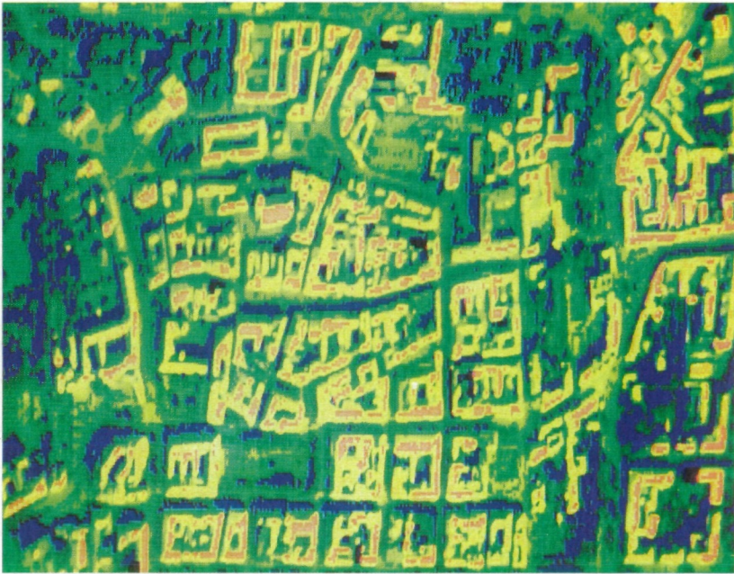
Abb. 9: Thermalbild der Innenstadt von Klagenfurt. 10. September 1979, 10 Uhr vormittag. Hergestellt mit dem Kanal 11 des Bendix-Scanners der DFVLR. Bildverarbeitung Institut für Geographie UBW Klagenfurt. Farbcodierung: blau unter 20° C, grün 20°–25° C, gelb 25°–30° C, orange über 30° C. Dem Temperaturdatenfeld ist zur Verbesserung des optischen Eindrucks ein Bild aus einem Kanal im Bereich des sichtbaren Lichtes als Schwarzweißinformation unterlegt. Die Bedeutung der Parkvegetation für den innerstädtischen Temperatureausgleich (dunkelgrün–blau) wird deutlich. Verwendungszweck Stadtplanung, Stadtklimatologie.
