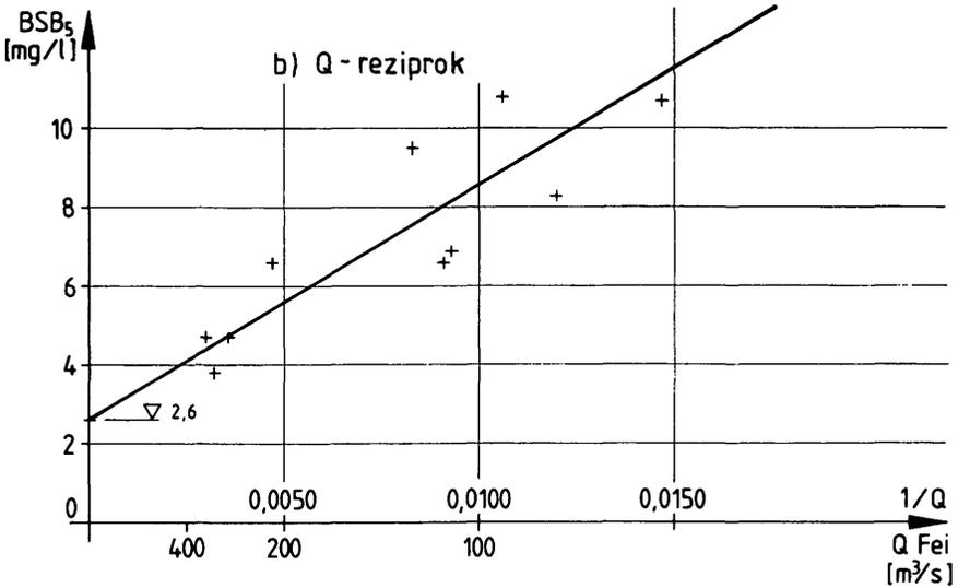
Abb. 2: Biochemischer Sauerstoffbedarf der Drau in Abhängigkeit vom Abfluß:
