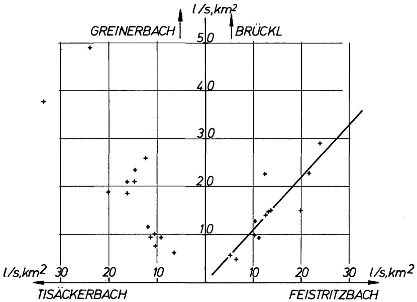
Abb. 4: Abflußpendenvergleiche zwischen Gebietspegel Brückl und Feistritzbach sowie Tisäcker- und Greinerbach.
