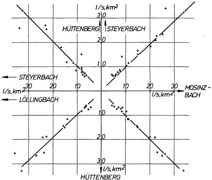
Abb. 2: Abflußpendenvergleiche der Zubringerbäche mit dem Gebietspegel Hüttenberg.
