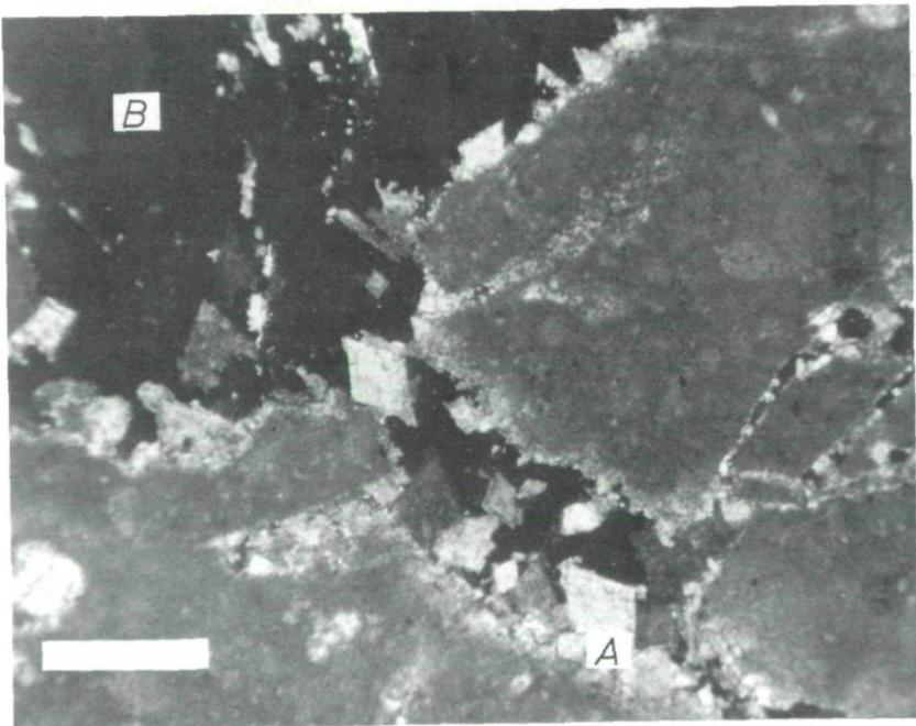
Abb. 3: LF-Gefüge mit Zement A (Dolomit) und Zement B (Fluorit) Schliff 20/21a, gekr. Nicols, Balkenlänge 1 mm.
