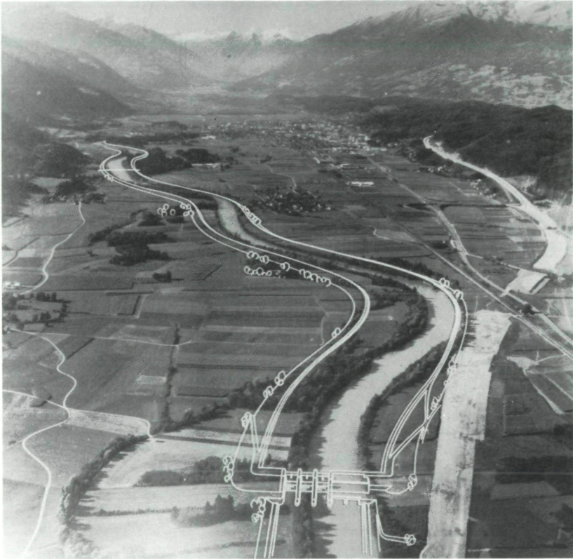
Abb. 1: Übersichtsschaubild des geplanten Draufkraftwerkes Molzbichl–Mauthbrücken.
