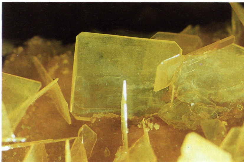
Abb. 4: Typische, nach der Basis dünntafelig entwickelte Wulfenite aus der Grube Stefanie, Konradi, 13. Lauf. Der Kristall in Bildmitte ist 1 cm groß. Sammlung und Foto: NHM Wien (Inv.-Nr. L 4524).
