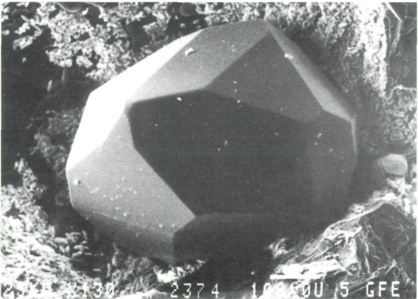
Abb. 2: Nitrobarit, vielfächiger Einzelkristall, REM-Aufnahme, 130fach vergrößert
