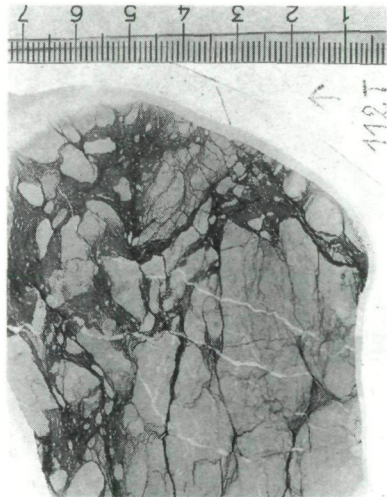
Fig. 16: 112, Gruppe B, ob. Daleje MF-Typ V.1: „Slump“. Re. Bereich zeigt eine durch Transport zerbrochene und aufgelöste Mudstonekomponente, die intern kontinuierlichen Übergang in sehr feinarenitischen Packstone und krümeligen Echinodermaten-Peloid-Grainstone aufweist. Relativ weiterer Transport ist gut gerundet, nur wenige mm-großen arenitischen Grainstone-Komponenten, z. T. als Stylocumulat auftretend, abzule- sen.
