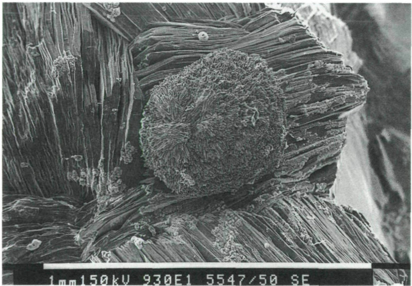
Abb. 6: Kugeliges Pumpellyit-Aggregat auf Chlorit (Leuchtenbergit), Talkbergbau Rabenwald, Bildbreite 1,3 mm (REM-Aufnahme: Zentrum für Elektronenmikroskopie Graz)
