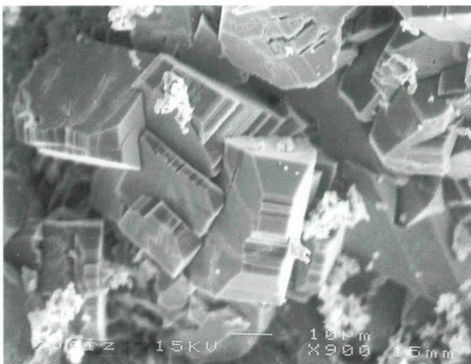
Abb. 9: Blockige Langitkristalle mit Parallelverwachsungen und Cerussit. Bergbau Oberzeiring, Steiermark.
