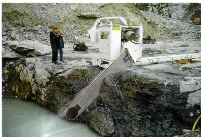
Abb. 6: Die Schwertsäge zur schonenden Gewinnung von Rohblöcken im Tiefbau. Foto: Archiv Kogler
