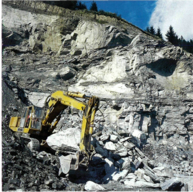
Abb. 3: Teilansicht aus dem Steinbruch Kogler, die einerseits die Lagerungsverhältnisse und die tektonische Überprägung der Gesteine zeigt, andererseits aber auch die stark wechselnde Massigkeit und Zerteilung. Foto: Archiv Kogler
