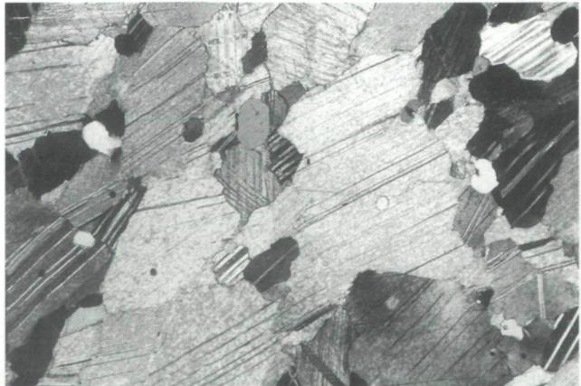
Nebengemengteilen erscheinen gerundete Quarzkörner mit glatter Auslöschung und gerade gestreckte Muskowitteilsten, untergeordnet treten kleine Quarzaggregate und Feldspäte auf (Abb. 8).
