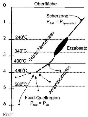
**Abb. 2:** Modell der Lagerstättenbildung durch prograde Metamorphose: Eine Scherzone ermöglicht durch erhöhte Permeabilität und durch Überleiten von lithostatischem zu hydrostatischem Druck die Fokussierung und das Hochströmen tiefer metamorpher Fluide. Erzabsatz tritt durch chemische oder physikalische Milieuveränderungen ein. Das System ist offen, der Massenstrom ist einseitig gerichtet.
