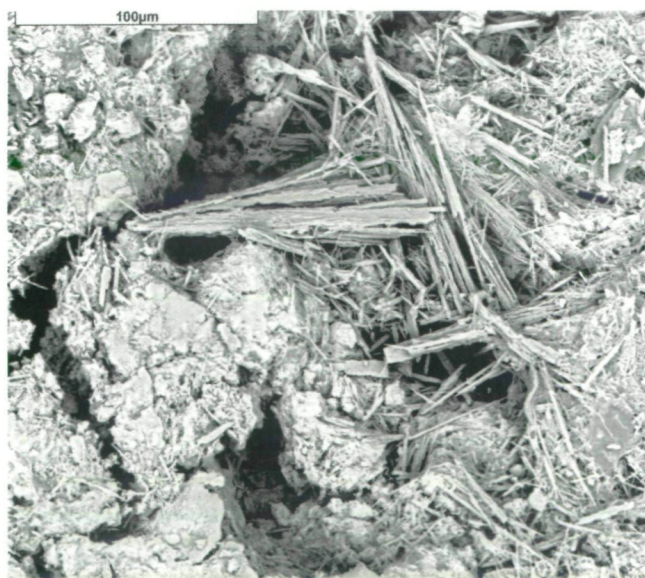
Abb. 1: Ferrierit von Knappenberg bei Hüttenberg, Kärnten. Die feinfilzigen, teils garbenförmigen Kristallaggregate sind morphologisch nur schlecht begrenzt. Elektronenmikroskopische Abbildung rückgestreuter Elektronen (BSE).
