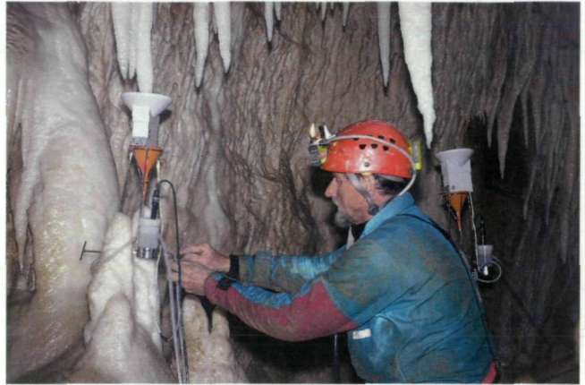
Abb. 18: In einem einmonatigen Rhythmus werden die teilautomatischen Messgeräte in der Obir-Höhle abgelesen und gewartet. Foto: H. Langer
