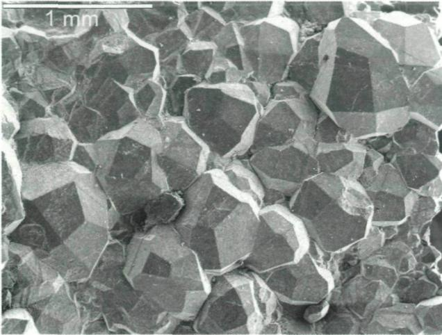
Abb. 3: Analcimkristalle mit der Morphologie des Deltoidikositetraeders {211}, Sommerau, Lavantal, Kärnten. REM-SE-Bild
