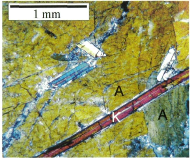
Von den Proben wurden polierte Dünnschliffe angefertigt, die mittels Durchlichtmikroskopie mit linear polarisiertem Licht und Rasterelektronenmikroskopie (REM) mit energiedispersiver Röntgenanalyse untersucht wurden.
