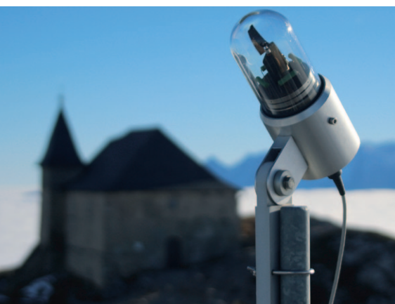
Abb. 9: Der Sensor für die Sonnenscheindauer (Type Solar 111 von Fa. Kroneis) hier am Dobratsch registrierte im Dezember 2016 die meisten Sonnenstunden Kärntens. Foto: Ch. Stefan
