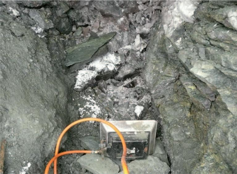
**Abb. 6:** Blick in die Kluft mit noch zu bergenden Mineralstufen, die mit Gesteinstrümmern im Eis eingebettet sind. Im Vordergrund der gasbetriebene Keramikbrenner. Bildbreite: 120 cm
