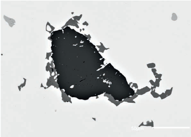
Abb. 2: Chalkopyrit (dunkelgrau), teilweise umhüllt von Tetradrit-(Fe) (mittelgrau) in Galenit (weiß). Im Chalkopyrit ist Elektrum (weiß) in Form winziger Tröpfchen eingeschlossen. Bournonit (hellgrau) ist als Einschluss im Galenit rechts und links oben zu sehen. Tauerngoldgang westlich der Goldbergspitze, Kärnten. REM-Foto (BSE-Modus); H.-P. Bojar
