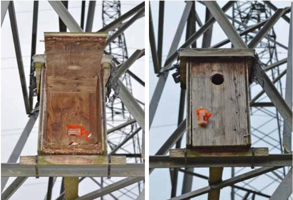
**Abb. 1: Im und am Nistkasten angebrachte Thermologger des Typs Tinytag Talk 2. Fotos: A. Kleewein**
