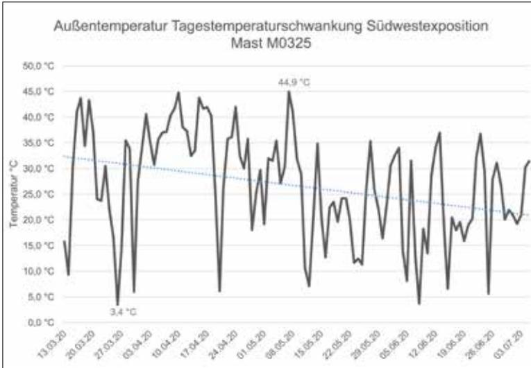
**Abb. 7: Tagestemperaturschwankung an der Außenwand des Nistkastens mit Südwestexposition am Mast M0325, aufgenommen von 13. März 2020 bis 5. Juli 2020.**
