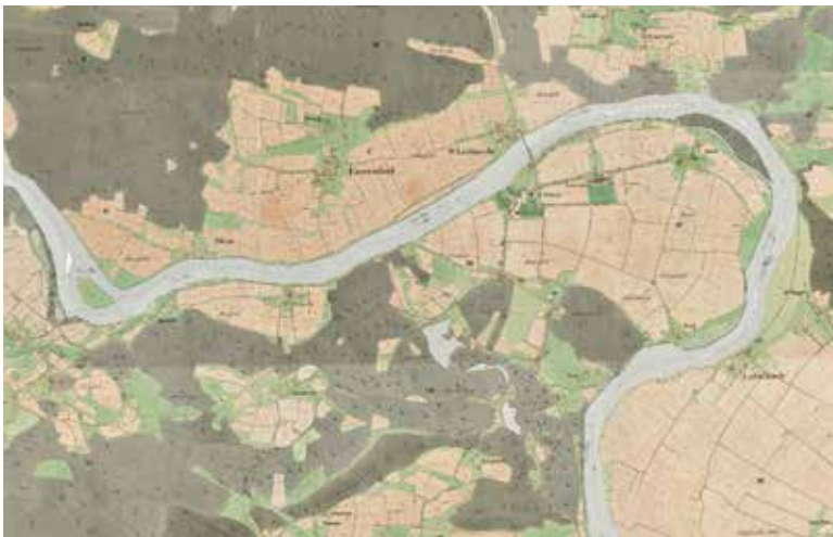
Abb. 3: Die Drau im Bereich der Rosegger Schleife zu Beginn des 19. Jahrhunderts. Der Fluss war zu dieser Zeit bereits kanalisiert und begradigt. Der Oberwasserkanal entstand erst im Zuge des Kraftwerksbaues in den 1970er-Jahren. (Quelle: Franziszeischer Kataster, KAGIS).
