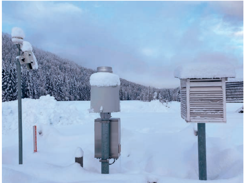
Abb. 6: Auch in den Karawanken wie hier im Bodental fiel im Jänner reichlich Schnee (maximale Schneehöhe 127 cm), Station des Hydrographischen Dienstes, Land Kärnten mit Schneepegel, Niederschlagswaage und Wetterhütte. Foto: Ch. Stefan am 7. Jänner 2021
