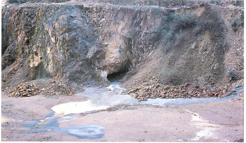
Tafel 1. a) Mundloch des Förderstollens (C) auf der untersten Steinbruchsohle im Jahr 1990 (mit nahe heranreichendem Schuttkegel).
