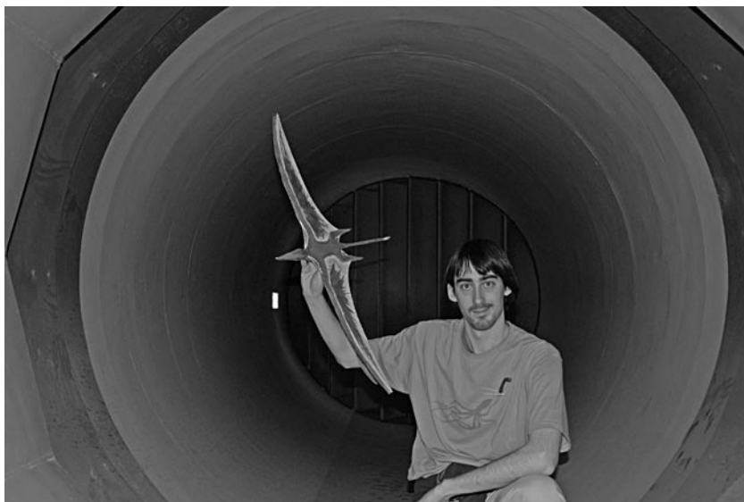
Abbildung 25. Flugversuche. Der Projektmitarbeiter ROSS ELGIN testet das Flugverhalten von Flugsauriern im Windkanal. – Foto: R. ELGIN.
