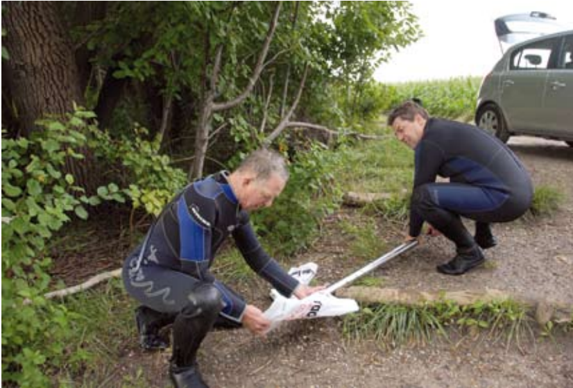
Abbildung 4. Der Bohrkern wird aus dem Rohr in eine Plastiktüte geschoben. – Foto: R. SCHOTTMÜLLER.
