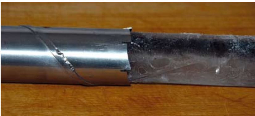
Abbildung 5. Nach dem Einfrieren wird der gefrorene Bohrkern durch sanftes Erwärmen aus dem Rohr gedrückt. – Foto: N. LEIST.
