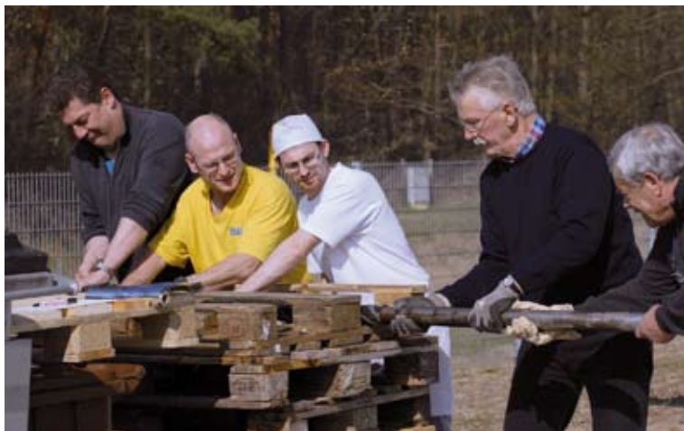
Abbildung 5. In der Bäckerei Visel wird das Doppelrohr angetaut, um den Torfkern unbeschädigt herausziehen zu können. – Foto: N. LEIST.
