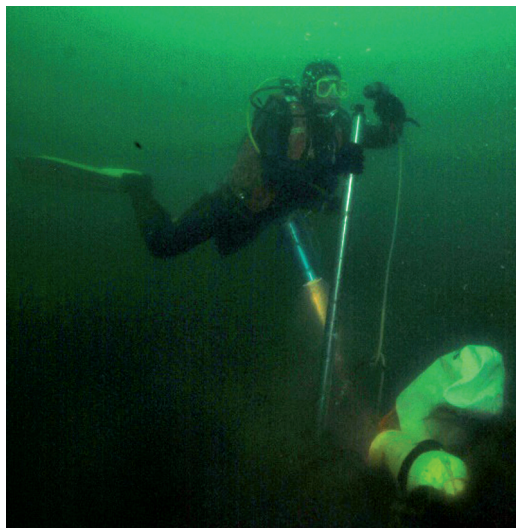
Abbildung 6. Bohren unter Wasser in 10 m Tiefe mit dem Schlagluftbohrer. – Foto: REINHARD SCHOTTMÜLLER.
