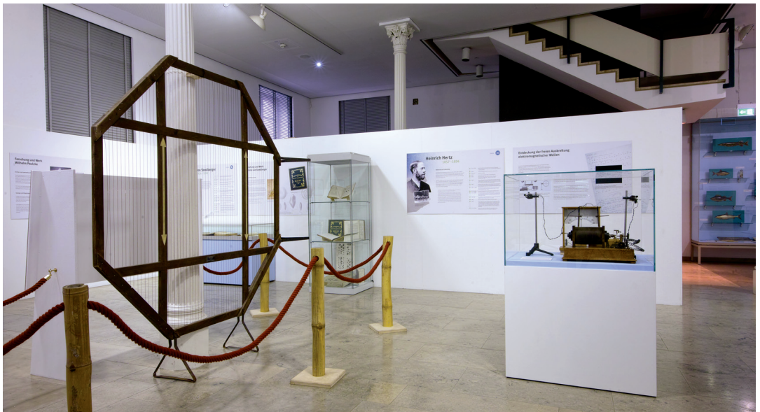
Abbildung 7. Im Vordergrund Versuchsapparaturen zu HEINRICH HERTZ, die vom Karlsruher Institut für Technologie (KIT), Fakultät für Physik, zur Verfügung gestellt wurden. Links das HERTZ'sche Gitter (in einem Nachbau von 1957), rechts Sender und Empfänger bestehend aus Funkeninduktor, zwei Antennen, Anzeigegerät und Akku. Die Originalgeräte befinden sich im Deutschen Museum in München. Am 13. November 1886 gelang HERTZ erstmals die Übertragung elektromagnetischer Wellen von einem Sender zu einem Empfänger. Der Drahtgitterpolarisator für elektromagnetische Wellen ist für Wellen durchlässig, deren elektrisches Feld senkrecht zu den Drähten schwingt. Bei Parallelität reflektiert das Gitter wie eine leitende Fläche.
